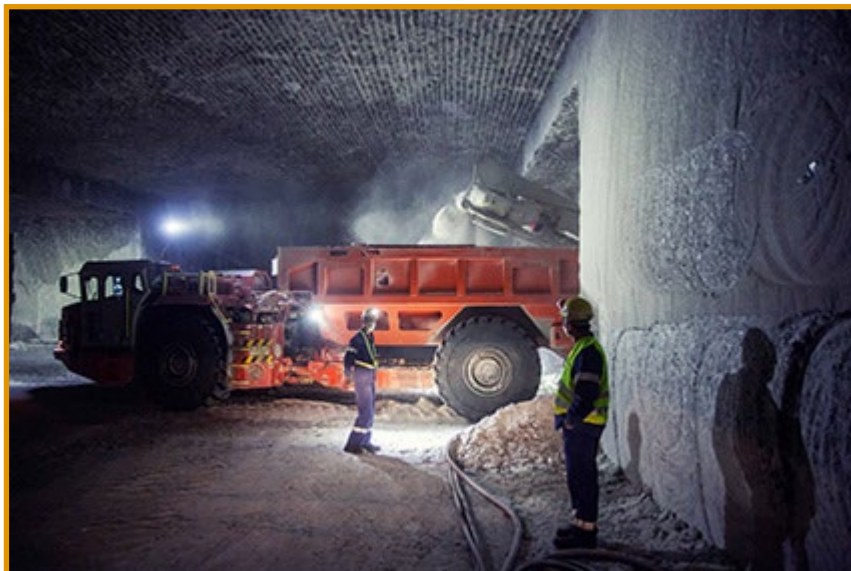
Ein Sandvik MB770 befüllt einen Sandvik TH540 Muldenkipper, der dann die Fracht zum Förderband transportiert (Fotos: Adam Lach)
