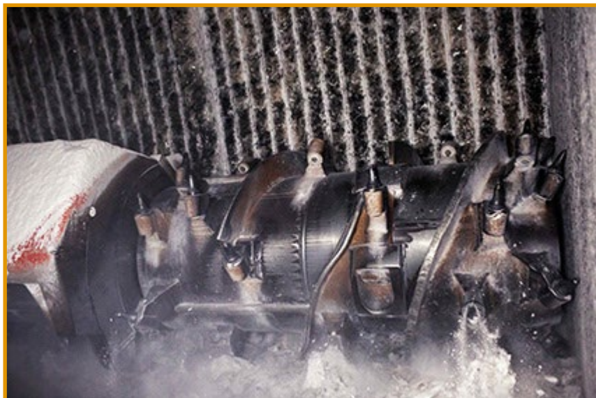
Für den Abbau von Steinsalz setzt Heilbronn auf drei Sandvik MB770 (Fotos: Adam Lach)
