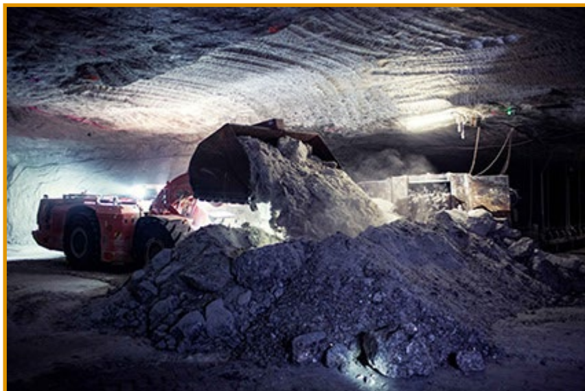
Ein Sandvik TH540 Schubkastenfahrzeug beim Abladen von Salz auf das Förderband des Heilbronner Salzbergwerks (Fotos: Adam Lach)
