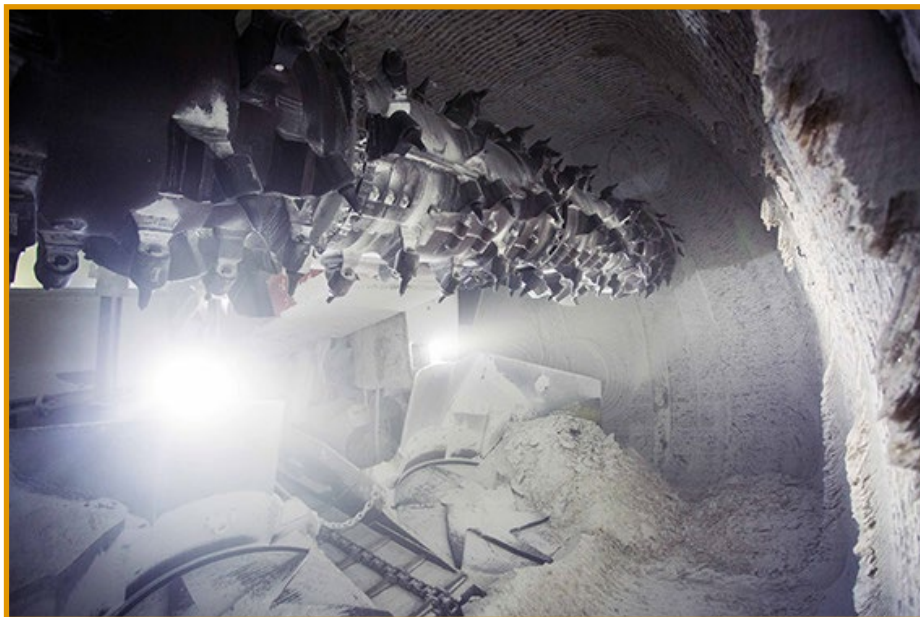
Ein Sandvik MB770 Continuous Miner an der Ortsbrust (Fotos: Adam Lach)
